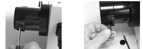
Schrauben Sie die Kohlenabdeckkappen an der Rückseite des Gerätes ab
